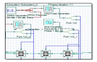
Fig. 3 DQPSK modulation scheme in Optisystem
